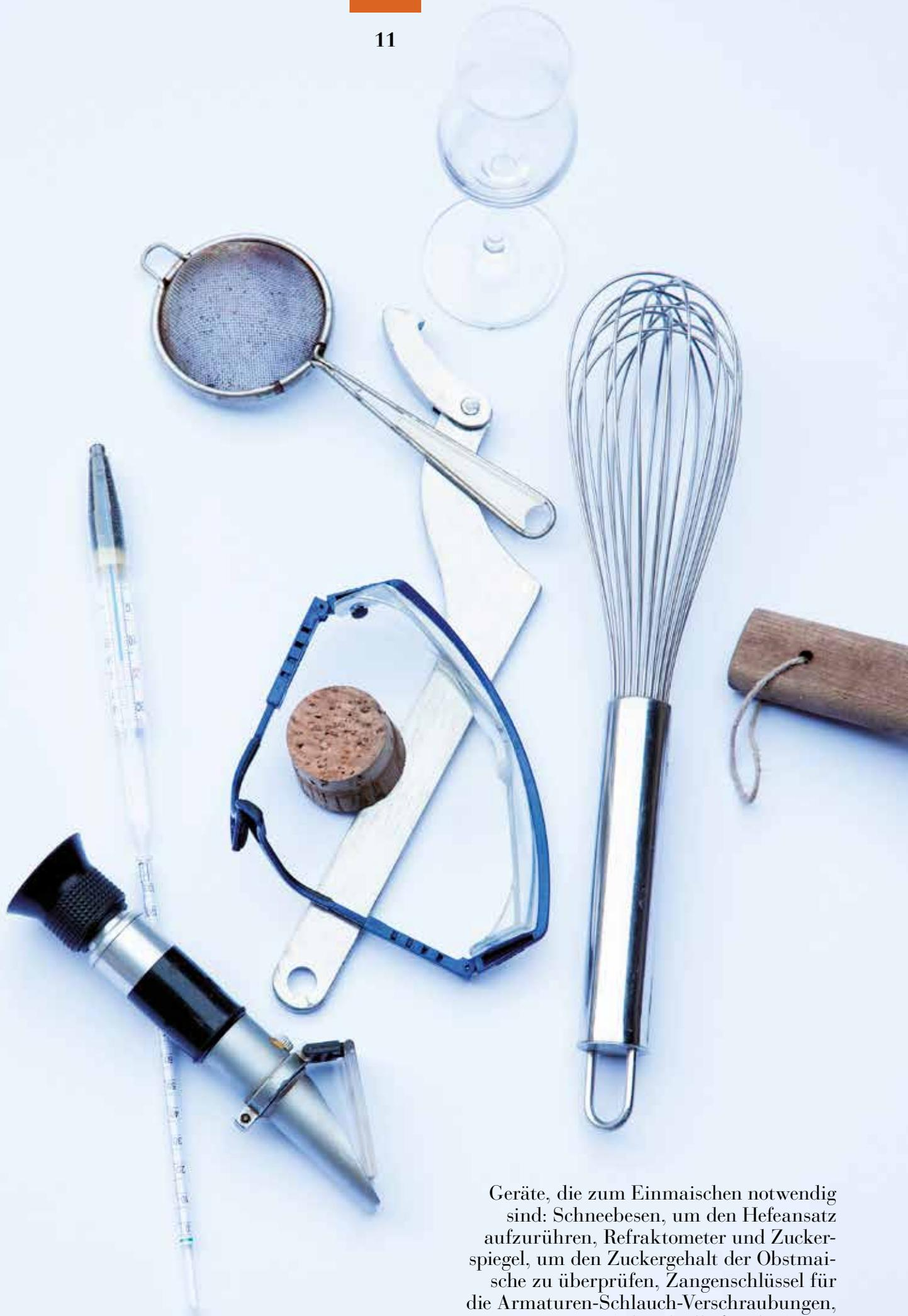
Geräte, die zum Einmischen notwendig sind: Schneebesen, um den Hefeansatz aufzurühren, Refraktometer und Zuckerspiegel, um den Zuckergehalt der Obstmaische zu überprüfen, Zangenschlüssel für die Armaturen-Schlauch-Verschraubungen, Schutzbrille für die Säure.
